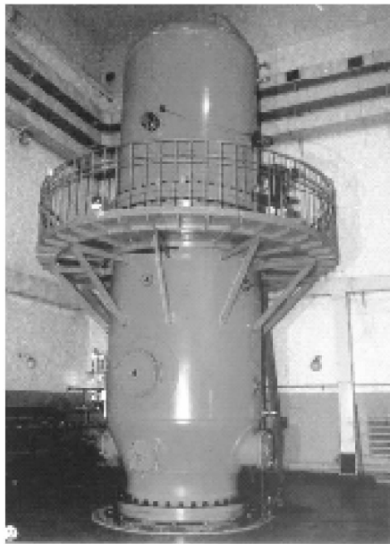
自行研制的 4.5 MV 静电加速器。
